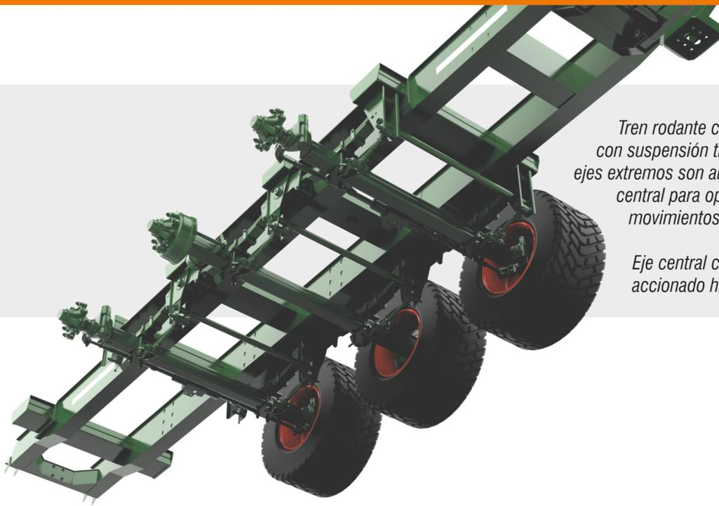
*Tren rodante compuesto de 3 ejes independientes con suspensión tipo ballestas, de los cuales los 2 ejes extremos son autodireccionales con bloqueo central para operaciones de alta velocidad y movimientos de reversa.*
