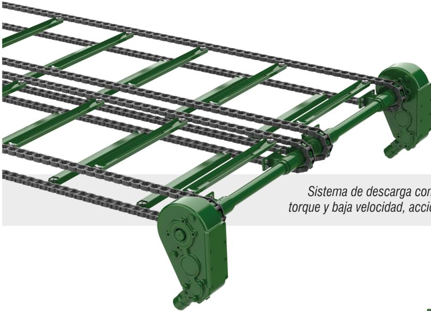
*Sistema de descarga compuesto por 2 reductores robustos de alto torque y baja velocidad, accionados por 2 motores hidráulicos.*
